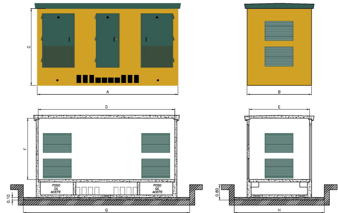
*Los modelos "A" mantienen las mismas medidas que los "B" salvo la altura interior y exterior (C y F)
